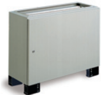
Основание с доступом спереди (серия CA и CN) или спереди и сзади (серия CD и CM) может комбинироваться с распределительной панелью или с верхней крышкой. Дверца (шириной 1000 мм) внутри усилена профилями.
