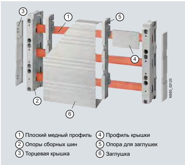
Система сборных шин 60 мм: основания в сборе до 630 А
