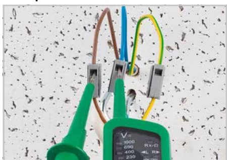
Измерение напряжения через отдельные тестовые гнезда.
