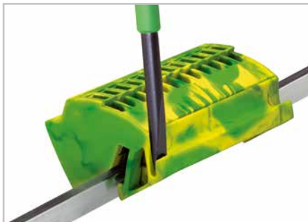
Разблокируйте правый и левый фиксаторы для снятия клеммы с заземлением. Затем снимите клемму с шины.
