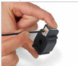
Монтаж проводника путем вставки в зажим.
