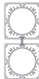
Рис. 2 Пример сборки многомодульного спортивного прожектора
